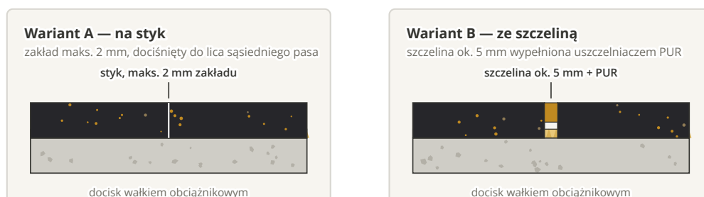
Rys. 3 — złącze podłużne w wariantcie na styk (A) albo ze szczeliną uszczelnianą PUR (B).
